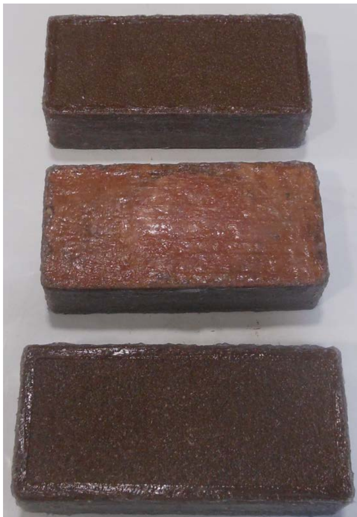
Figura 1. Campioni di prova dopo trattamento di sigillatura.
