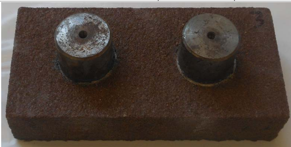
Figura 1. Campione di “Suberite” applicato su supporto in calcestruzzo utilizzato per le prove.
